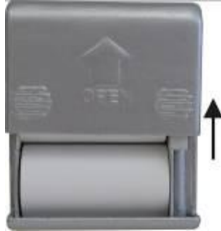
Рисунок 7 – Снятие крышки с приборного блока
