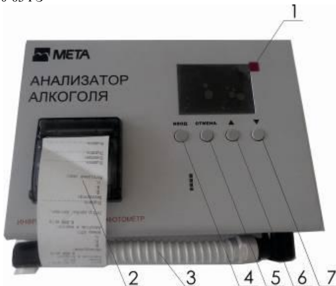
1- Жидкокристаллический индикатор; 2- Принтер; 3-Проботборник; 4,5,6,7 –Кнопки управления.
