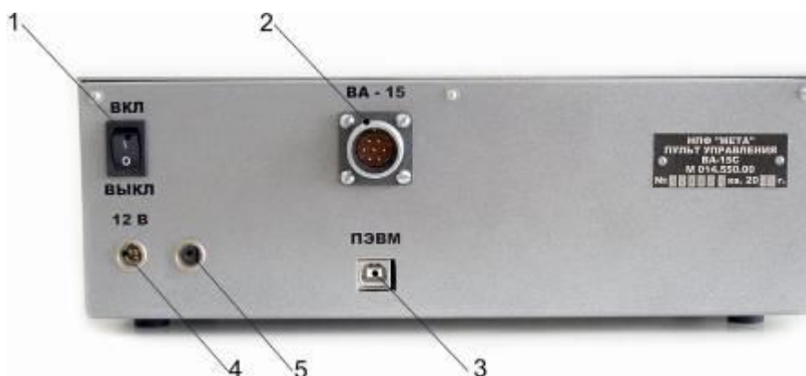
Рисунок 3а – Терминал управления весами. Вид спереди
