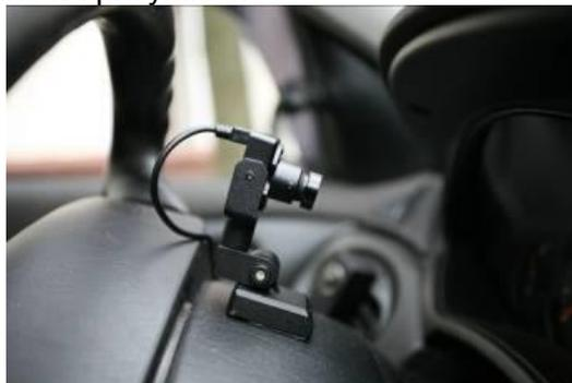
Рисунок 5– Внешний вид видеодатчика для наблюдения за панелью приборов на рулевой колонке
