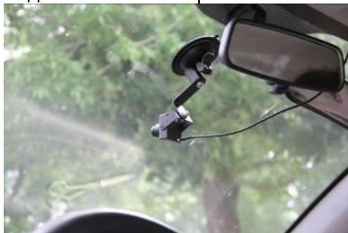
Рисунок 4б – Внешний вид видеокамеры общего вида на лобовом стекле автомобиля
