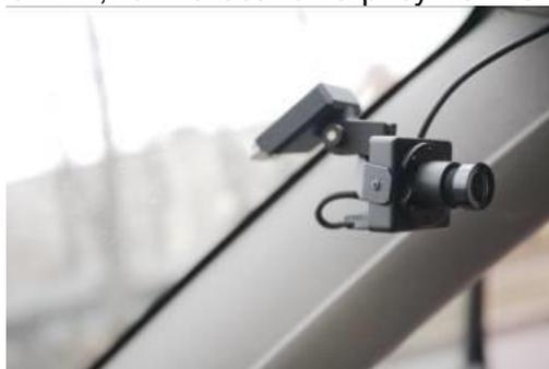
Рисунок 4а – Внешний вид видеодатчика общего вида и видеокамеры для наблюдения за действиями водителя и пассажиров на лобовом стекле автомобиля
