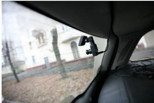
Рисунок 3 – Внешний вид видеодатчика общего вида на заднем стекле автомобиля
